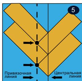
Продолжайте укладку планок «А» и «В», пока не дойдете до противоположной стены помещения. Обратите внимание, что одна из двух укладываемых планок может не доставать до стены. Следите за линейностью укладки узора, для чего используйте привязку к осевой линии в процессе укладки. Поправляйте уложенный массив при необходимости (рис. 5)
