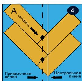
Поместите собранный фрагмент вдоль осевой линии, которая позволит укладывать узор правильно. Для этого найдите центр планки «А», как показано на рис.4 **Не используйте внешний угол «V», образованный двумя планками, в качестве привязочной линии.**
