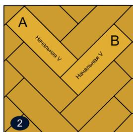
Линия стыка двух досок не должна выделяться над поверхностью планок (для проверки проведите пальцем вдоль линии шва, проверьте правильность расположения планок относительно друг друга и, при необходимости, простучите шов резиновой киянкой еще раз).
